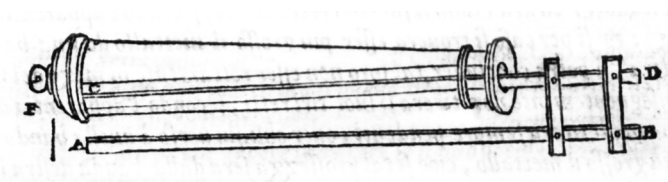
FIG. 52 – Technique pour mesurer le parallélisme de l'âme d'un canon selon Tartaglia, Quesiti et inventioni diverse , Venise, 1546. Document appartenant aux collections de la bibliothèque de l'Académie d'artillerie de Ségovie.
